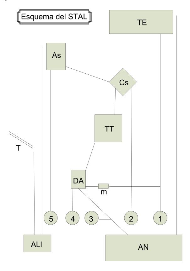
Figura 1. Esquema del Sistema de Tratamiento de Agua para Laboratorio.
