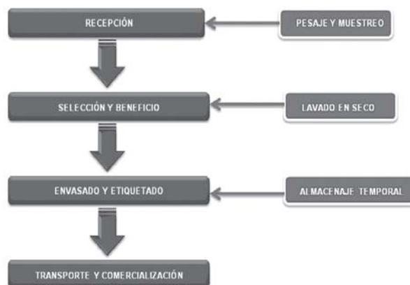
Figura 1. Esquema del flujo operacional de la planta de beneficio y empaque de frutas y vegetales que emplea las tecnologías convencionales de manejo postcosecha (P1)
